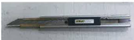
② オルファ社の刃先が30°のカッター。鍍金端部の巻き込み部分を残すカットをするときに役立つ。
