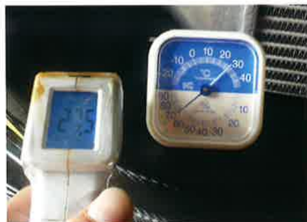
ラッピング施工前には毎回必ず気温・湿度とクルマのボディ表面の温度を計測しておきたい。
