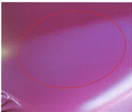
塩ビフィルムを伸ばし過ぎると、分子間の結合が破断して隙間に空気が入り「白化(クレーズ)現象」が起きる。
