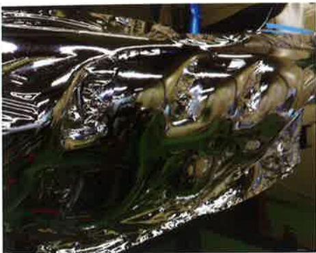
桜井の「Star Metal」を使った事例。指の跡はついているが、カットしたフィルム端部の形状はそのままになっている。端部は伸ばさず、伸ばしたいところだけを伸ばせば、施工後の剥離は極端に少なくなる。
