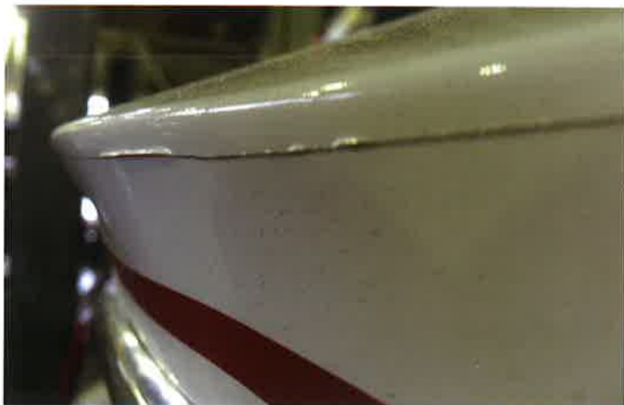
シートの切れ目で、シートを伸ばしたまま施工し終わると、一見綺麗に貼ったように見えても後から剥離してしまふ。
