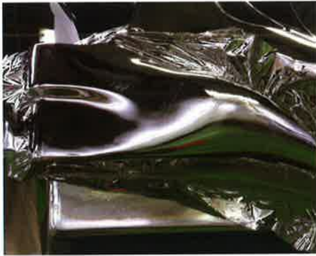
桜井の「Star Metal」を使った事例。指の跡はついているが、カットしたフィルム端部の形状はそのままになっている。端部は伸ばさず、伸ばしたいところだけを伸ばせば、施工後の剥離は極端に少なくなる。
