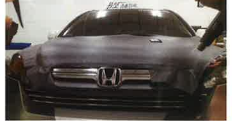
2013年9月に訪れたMAX PLUSの台湾本社では、カレンダー製法のフィルムでも日常使用して2年間剥離がないという車両を見た。ジョイントを間違えないことと、細部をカレンダー製法の特性に合わせて処理することが大切。
