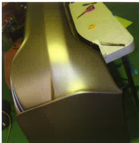
形状によっては1枚貼りと剥離してしまい、ジョイント施工が必要な場合もある。ジョイントのカットには、右ページで紹介している「ナイフレステープ」の「フィニッシュライン」が「デザインライン」が最適。
