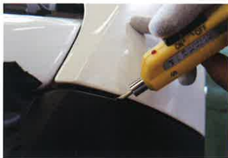
フィルムの端部はポストヒーティングをかけにくい所もあるので、「ラップヒートナイフ」で局所に熱を与える「スポットヒーティング」が効果的。
