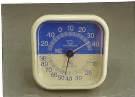
ラッピング施工時には、毎回作業場所の温度・湿度を計測しよう。温度・湿度はフィルムに大きく影響する。
