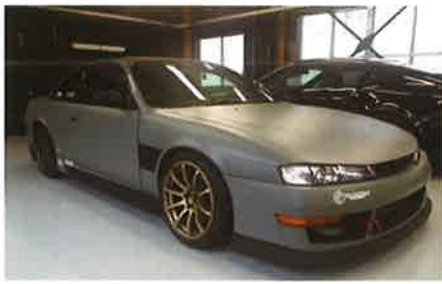
KPMFのフィルムでラッピングしたシルビア。フィルムを理解していれば、カレンダー製法のKPMFやMAX PLUSでも剥離のない施工ができる。
