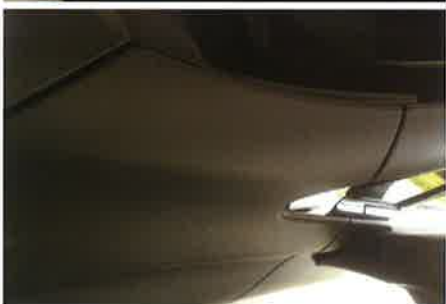
カーラッピングにおいて車両の造形を観察することは非常に重要。まずはプレスライン（キャラクターライン）を見極めて、その部分にフィルムの1枚貼りが可能なのか検討する。
