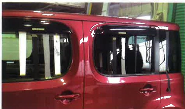
ポストヒーティングが効果的かどうかを確かめる方法。8×20cmくらいにカットしたフィルムを2枚用意し、40～50℃の熱を与えて、長手方向に120%以上伸ばしてガラスに貼る。一度常温まで戻してから、一方は92℃を目安にヒートガンで過熱し、もう一方は常温のまま、それぞれにカッターで切れ目を4～5箇所入れる。ポストヒーティングが効くフィルムであれば、過熱したほうは縮まず、過熱しなかったほうは切れ目から縮んでくる。
